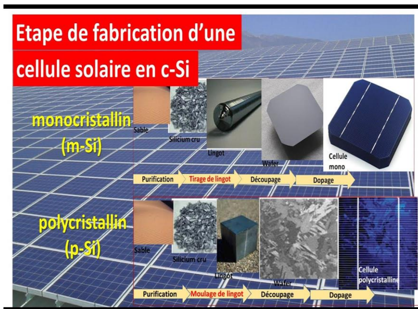
Figure I.10 : cellule solaire en silicium monocristallin et poly-cristallin [22].
