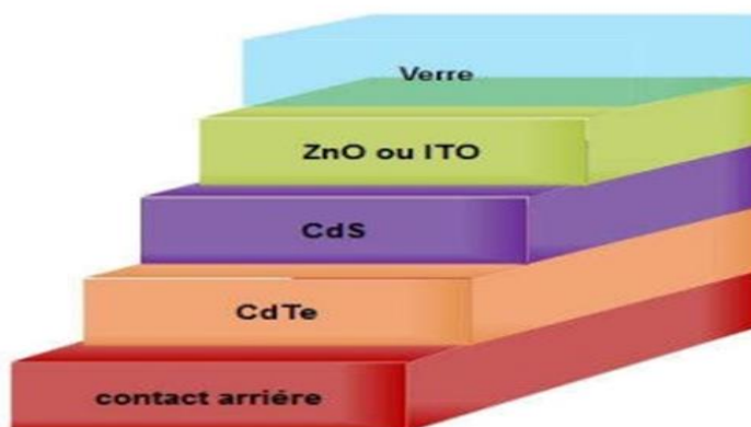
Figure I. 14 : Structure d'une cellule photovoltaïque au CdTe [8].
