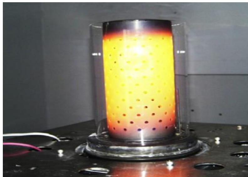
Fig.2.8. Image d'un émetteur thermique[44] [45].
