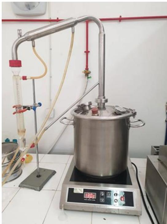
**Figure 69: Méthode de distillation par entrainement à la vapeur d'eau**
