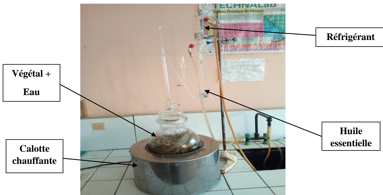
Figure 24 : Montage d'hydrodistillation type de Clevenger
