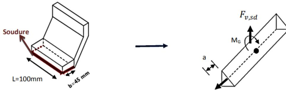
Pour :  $t_{max} \leq 17 \text{ mm}$   $a_{min} = 6 \text{ mm}$
