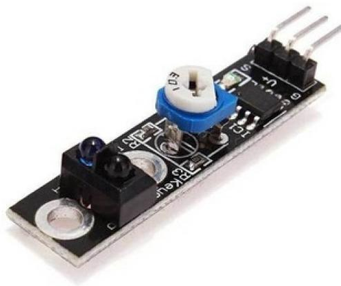
FIGURE 5.11 – Module suiveur de ligne KY-033
