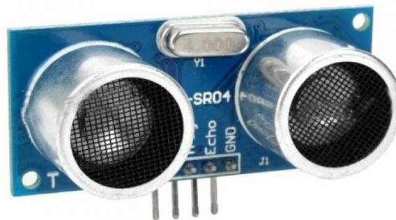
FIGURE 5.10 – Capteur ultrason HC-RS04
