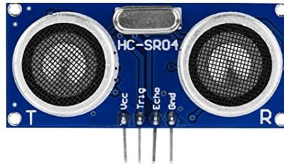
FIGURE IV.8 – Capteur ultrason HC-SR04
