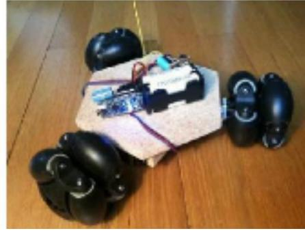
FIGURE II.12 – Robot de type omnidirectionnel
