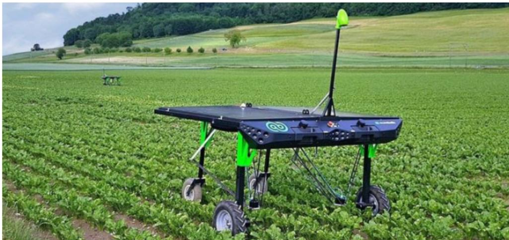
FIGURE I.4 – Le robot Ecorobotix cible les mauvaises herbes
