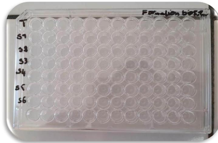
Figure 20 : Microplaque de 96 puits
