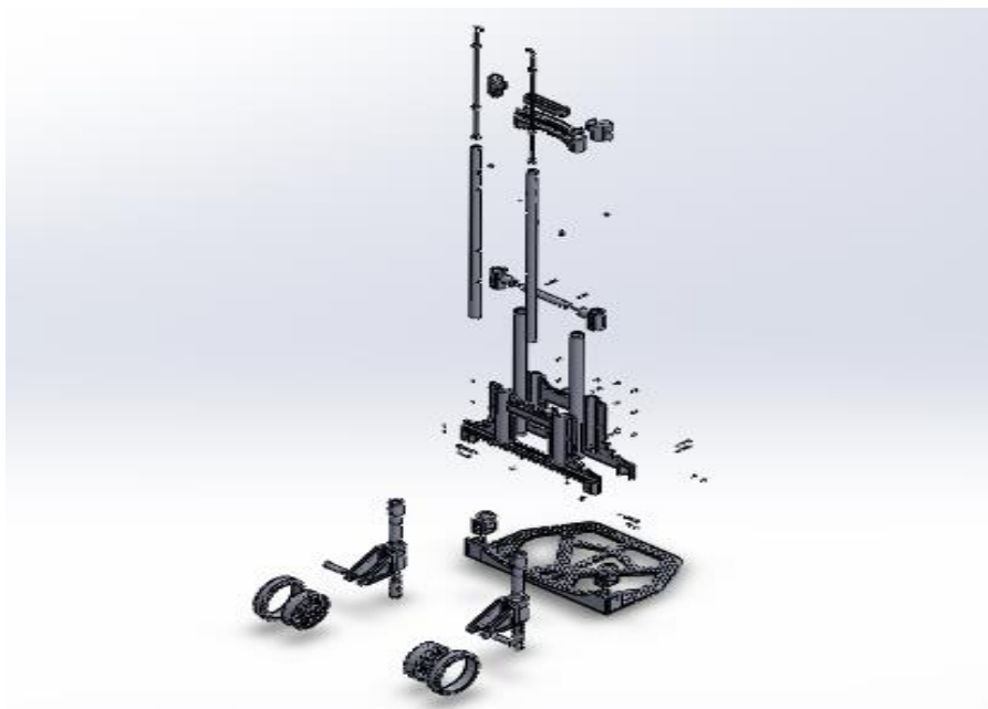
Figure III 85: Vue éclatée du chariot
