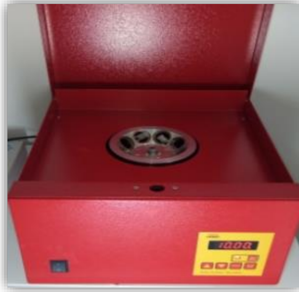
Figure 3: Une photographie lors de la mise du butyromètre dans la centrifugeuse.
