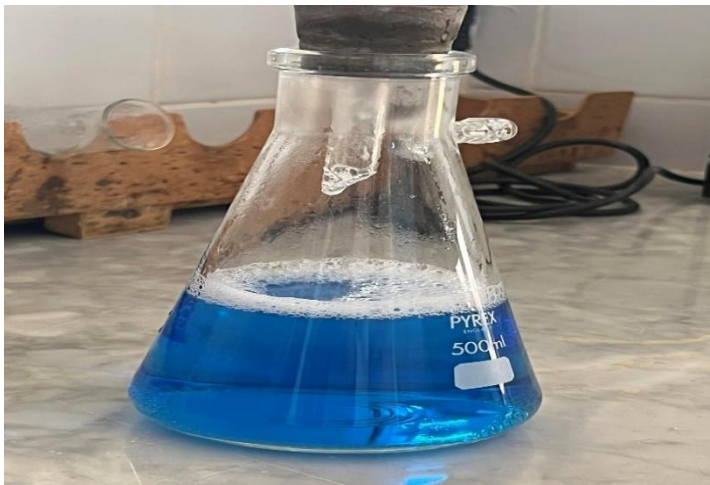
Figure 7: neutralisation de l'acide par quelques gouttes de Noah aqueuse en présence d'un indicateur phénolphtaléine
