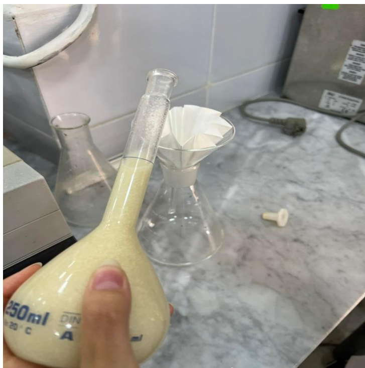
Figure 8: Filtration avec un papier filtre plissé ( photo originale )
