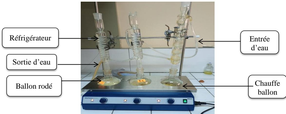
**Figure 22** : Montage d'extraction à chaud sous reflux (Photo prise au laboratoire)
