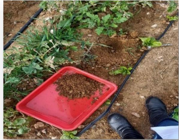
**Figures N° 11 et 12 : Prélèvement des échantillons du sol avec une binette**
