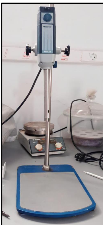
Figure 17 : Homogénéisateur (photo originale)
