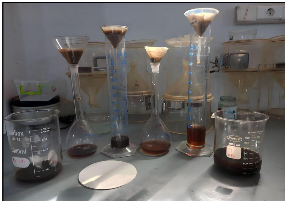
Figure 26 : Extraction éthanolique de la parche de café et filtration avec papier filtre (photo originale)
