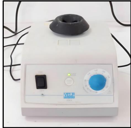
Figure 20 : Un agitateur (photo originale)
