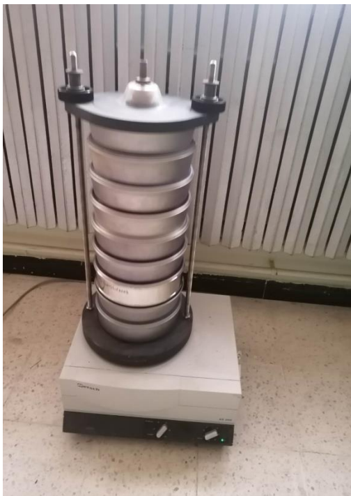
Fig. 07 : Tamiseuse. Fig. 08 : Résidus de refus pour Chaque ouverture de tamis.
