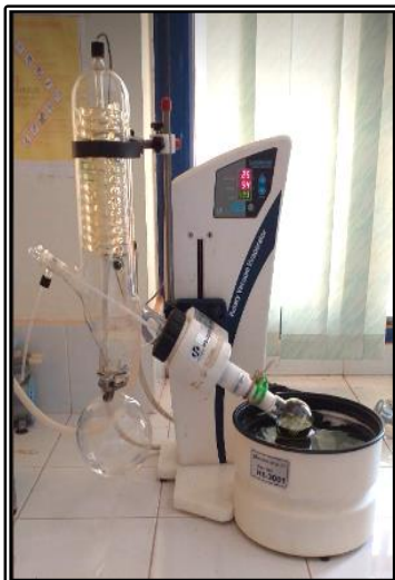
Photo 6 : Évaporation sous vide des phases.
