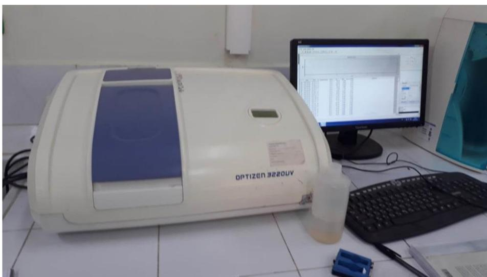
**photo 13** : spectrophotomètre UV-visible.
