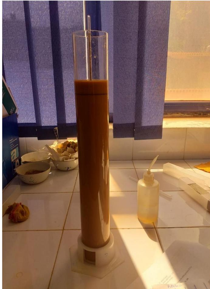
Photo 14 - Suspension sol + eau en éprouvette.
