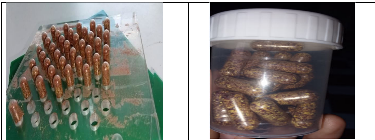
On monte le premier bout des gélules dans la gélulier on remplit notre poudre dans cette dernière puis on fixe bien le deuxième
