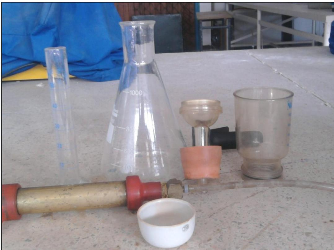
**Photo 1.** Appareillage nécessaire pour mesurer la quantité de matières en suspension
