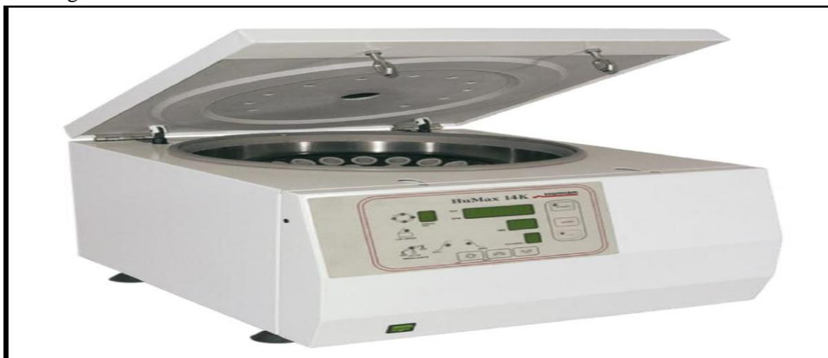
**Figure 42 :** Centrifugeuse HUMAN HUMAX1
