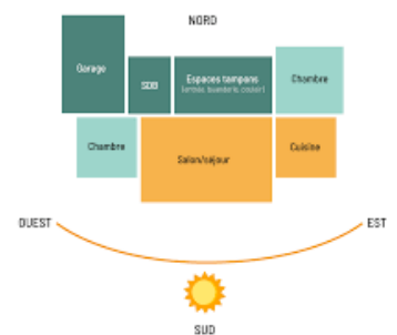
Figure 9 Exemple de disposition des espaces intérieurs
