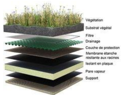
Figure 148 Les composants d'un toit végétal Source : Pinterest
