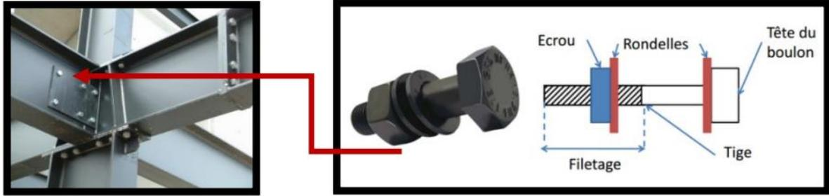
**Figure 79** : Système de boulonnage comme moyen d'assemblage de la structure. (Source : slide-Share de structure métallique)
