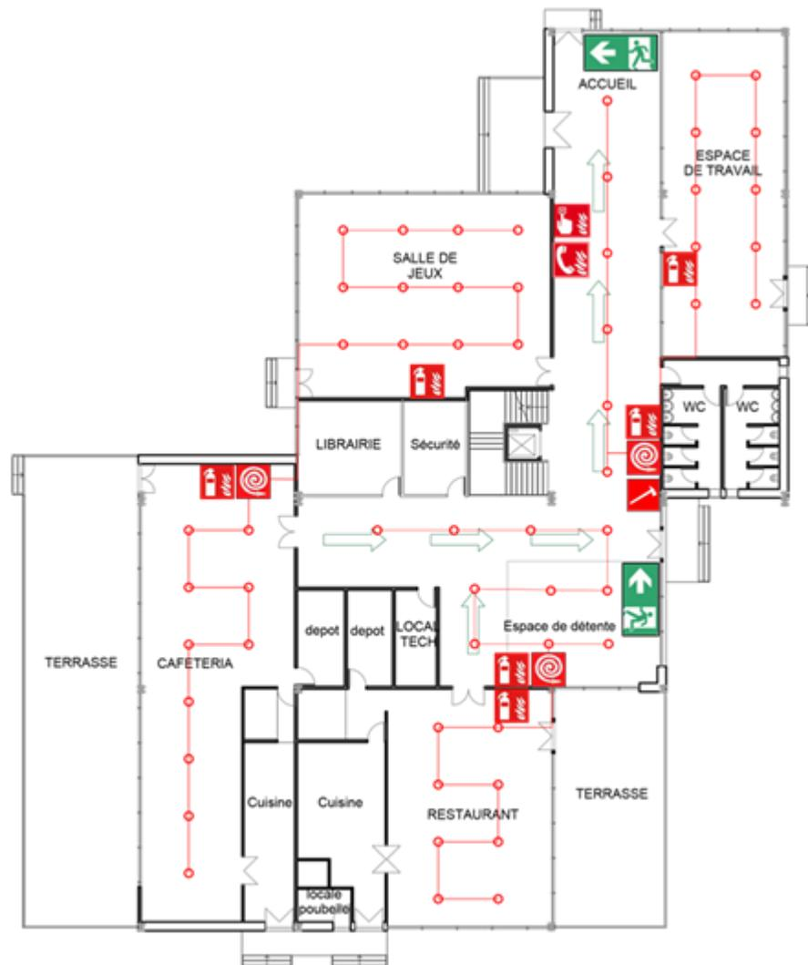
**Figure 88** : Plan de l'installation pour la protection contre les incendies (Voir Annexe) (Source : auteur)
