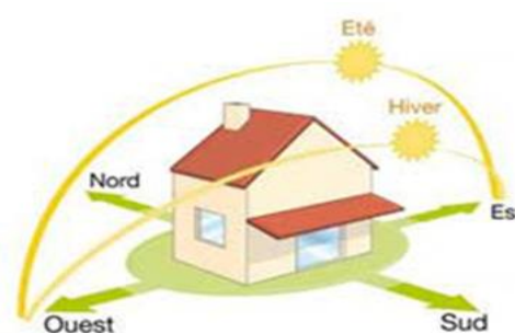
Figure 16 : L'orientation du bâtiment
