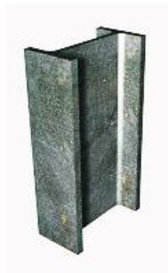
Figure 163 : Poteau métallique en I
