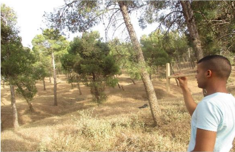
Photo 3 : Estimation de la hauteur à l'aide de dendromètre croix du bûcheron.
