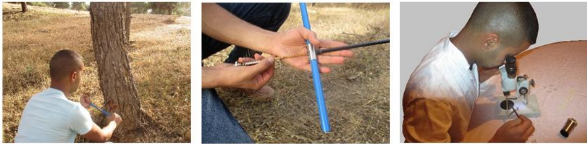
Photo 5 : Détermination de l'âge des arbres dominants ( à gauche : sondage par tarière de Pressler. au centre : extraction des carottes. à droite : comptage des cernes des carottes sous loupe binoculaire). (Photo de l'auteur, 2016)
