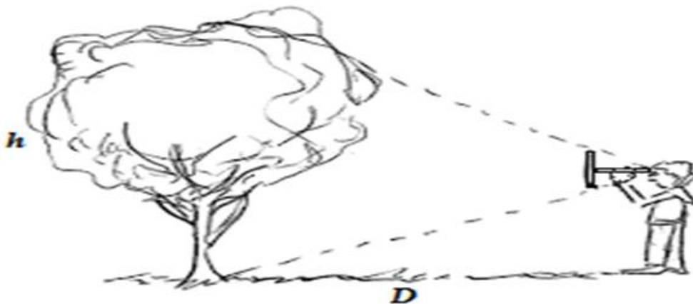
Figure 19 : Principe d'utilisation de croix de bûcheron.
