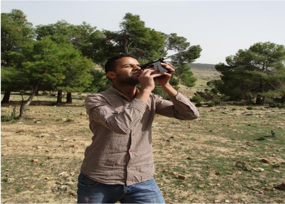
Photo 4 : Mesure de la hauteur à l'aide de dendromètre Blume-Leiss.
