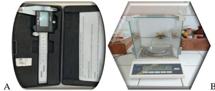
**Figure 10.** (A : Pied à coulisse ; B : Balance de précision) (originale)..
