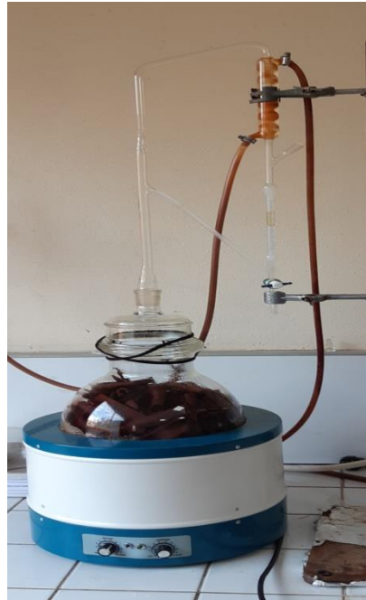
Figure 46: Montage d'hydrodistillation de type Clevenger
