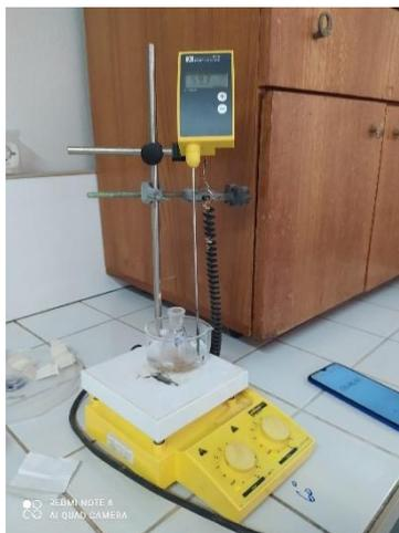
**Figure 19 : Agitation du mélange avec chauffage à différentes températures**
