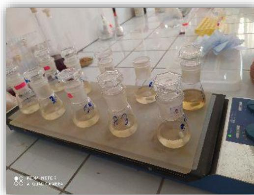
**Figure 15:** Préparation du point de charge nulle sur agitateur multi-poste.
