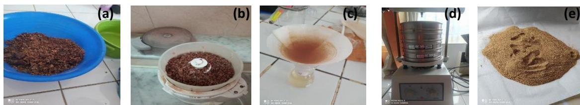
**Figure 14:** étapes de préparation du biosorbant (a) lavage, (b) broyage, (c) lavage, (d) tamissage, (e) poudre fine de 250 $\mu\text{m}$ .
