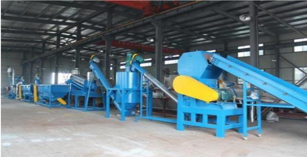
Figure.10: Unité de broyage, lavage et séchage. ( www.google.com .)
