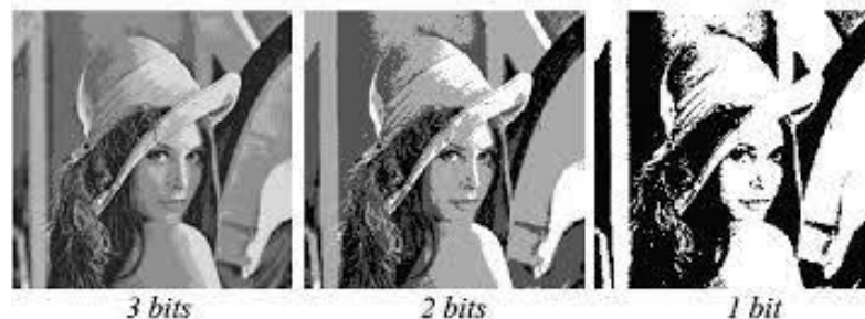
Figure 3: Exemple d'image utilisant une quantification de 1 bit/composante primaire
