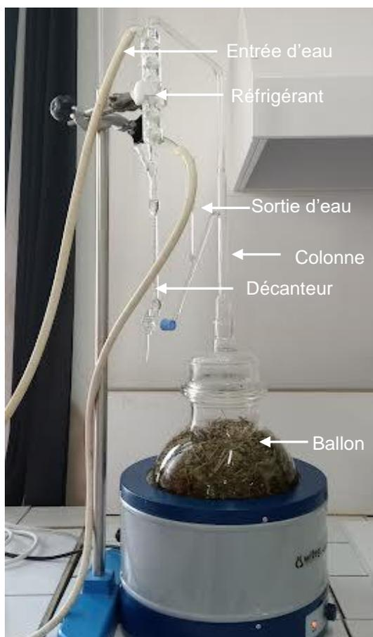
**Figure 19** : Dispositif d'hydrodistillation type Clevenger (photo originale).
