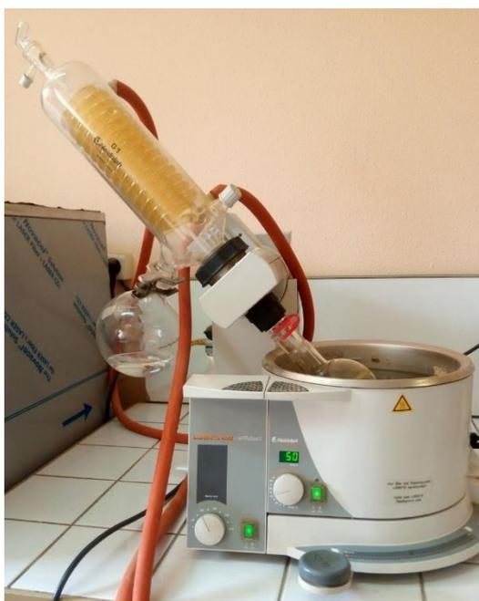
**Figure 21 :** Evaporateur rotatif HEIDOLF LABOROTA 4000 (photo originale).
