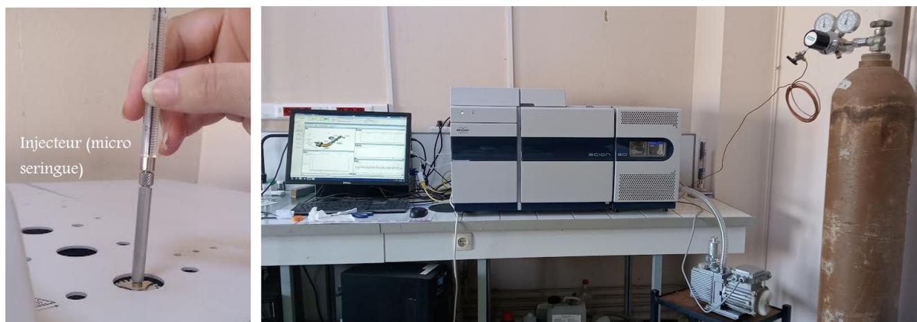
**Figure 20** : Chromatographie phase gazeuse couplée à un spectromètre de masse (photo originale).
