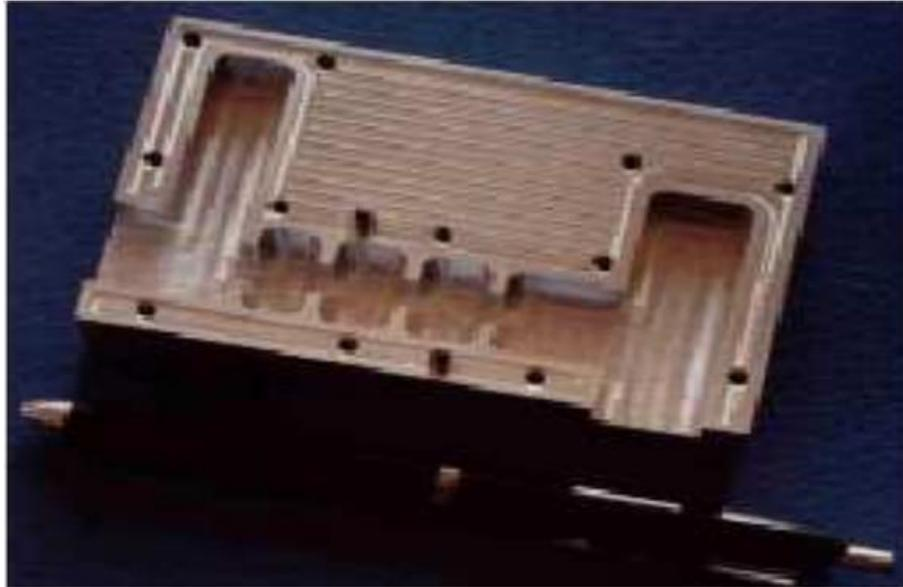
**Figure II.13 : Filtre en guides d'ondes à nervures [17]**
