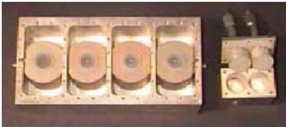
**Figure II.14 : Filtre à résonateurs diélectriques [17].**
