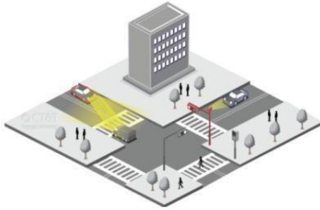
Figure I. 18 : Liaisons LAN-OWC : réseau véhiculaire utilisant la technologie VLC où les véhicules communiquent entre eux à base des LEDs (applications moyennes portées OWC) [I-46].
