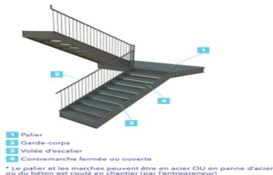
**Figure 119:** Escalier métallique **Source :** <https://www.tmssysteme.com/>
