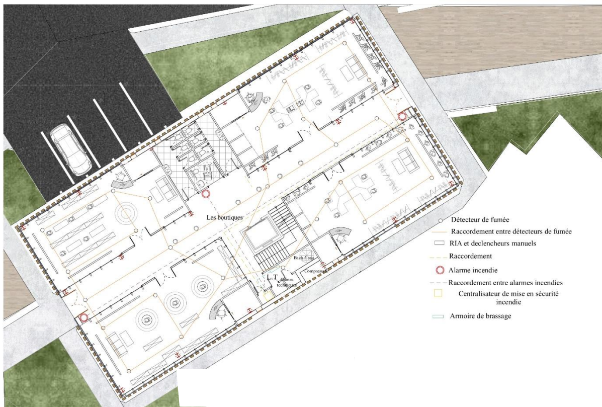
Figure 71 Plan schématique de l'installation du système pour la protection contre les incendies Source : auteur
