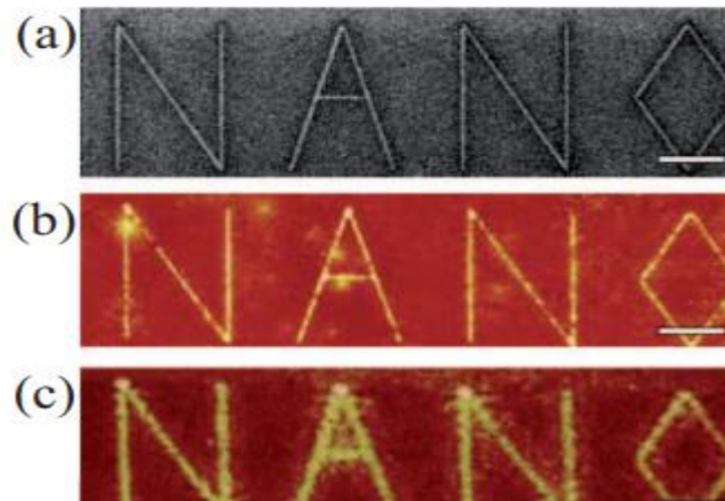
Figure I.25 : (a) Image réalisée avec un faisceau d'ions focalisés, (b) Image développée sur résine photosensible avec une lentille argent, (c) Image développée sur résine photosensible sans une lentille argent. Photos tirées de [42].
