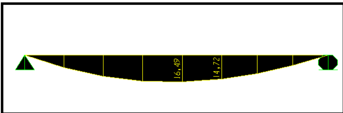
Figure 4.4 : Diagramme des moments à ELS
