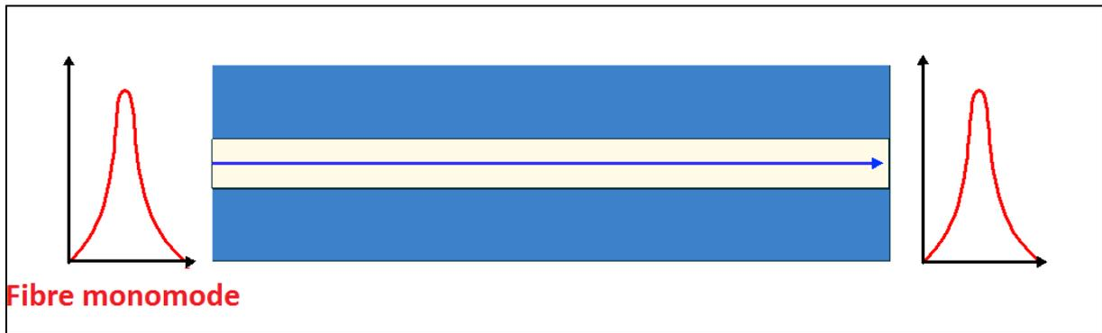
Figure I.5 : Trajet lumineux dans une fibre monomode.
