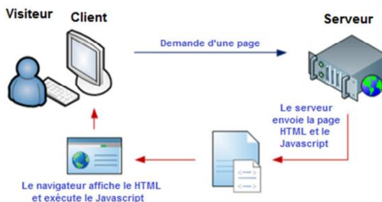
Figure IV.4 : Principe de fonctionnement d'un script coté client.
