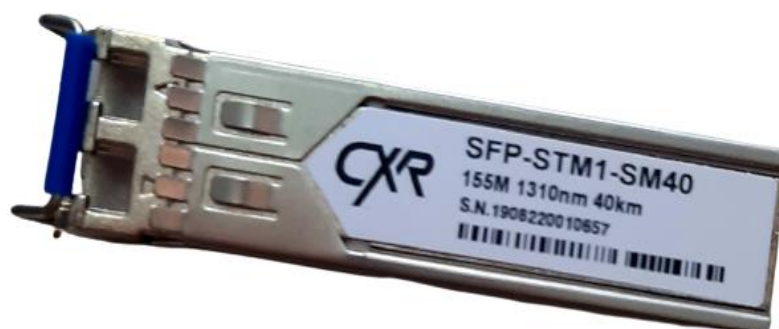
Figure II-3 : SFP pour fibres monomodes.
