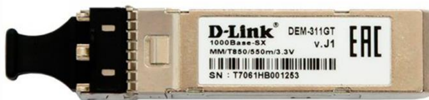
Figure II-2 : SFP pour fibres multimodes ( D-Link, s.d. ).
