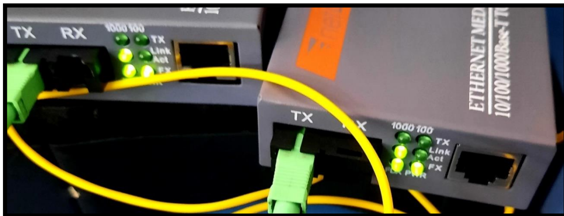
Figure III-4 : Connexion de deux MCs et vérification des voyants.
