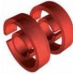
(a) : réseau de fils métalliques cylindriques (b) : réseau de résonateurs circulaires coupés (c) : associations des deux réseaux précédents
