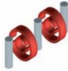
(a) : réseau de fils métalliques cylindriques (b) : réseau de résonateurs circulaires coupés (c) : associations des deux réseaux précédents
