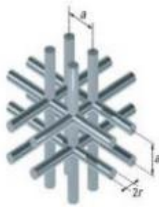
(a) : réseau de fils métalliques cylindriques (b) : réseau de résonateurs circulaires coupés (c) : associations des deux réseaux précédents
