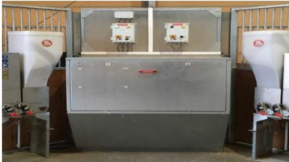
**Figure 181 Appareil COMBIFEED pour distribution automatique d'alimentation à l'intérieur**
