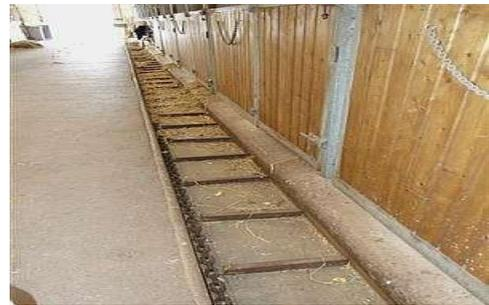
Figure 191 Chaîne mécanique du fumier
