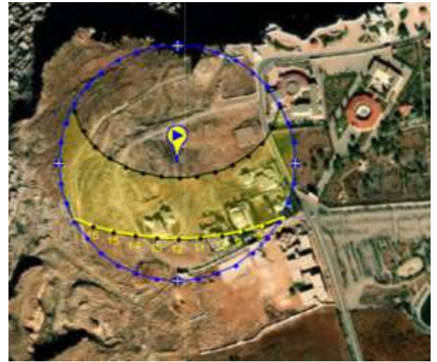
Figure 114: Schéma de la course solaire sur le terrain.
