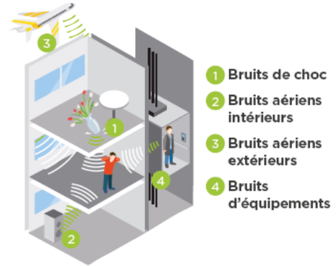
Figure 5 : l'isolation acoustique dans le bâtiment
