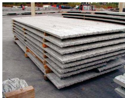
Figure 19 Le plancher en prédalle
