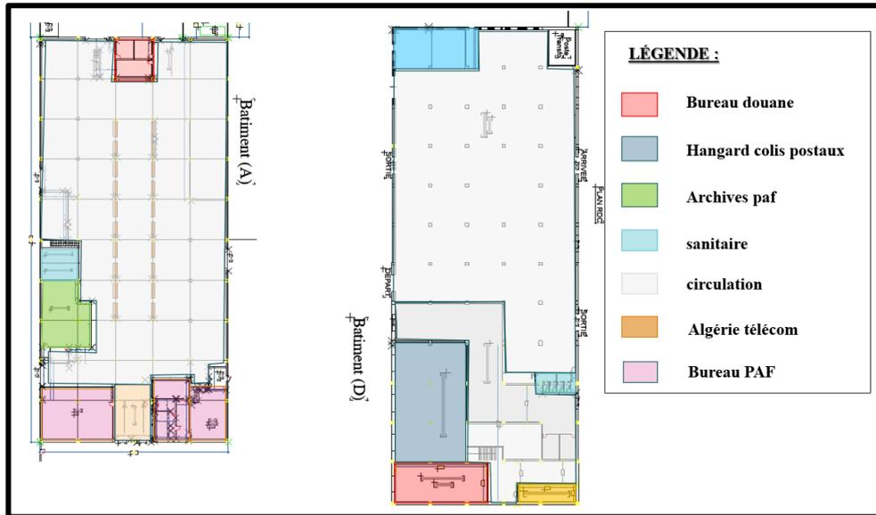
**Figure 25. Représentation du plan rdc du bloc (A) et (D)**
