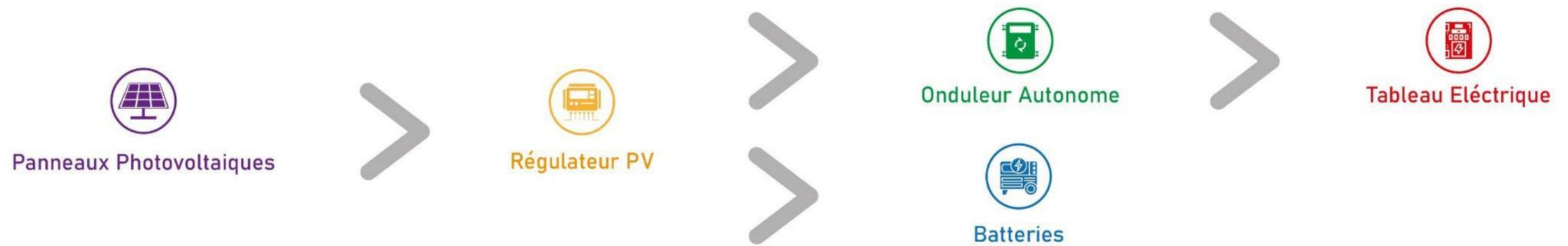
Figure 200 : Système panneaux photovoltaïques.
