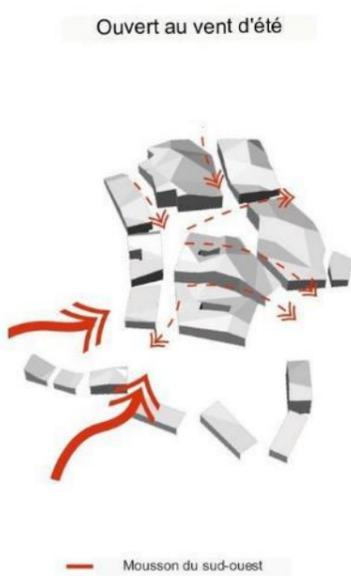
Le regroupement de blocs légers au sud est réalisé dans le but de profiter des vents d'été pour la climatisation de l'intérieur. Cette disposition permet de favoriser la circulation naturelle de l'air et l'apport de brises rafraîchissantes à l'intérieur du centre. Cela contribue à une meilleure régulation thermique et à une réduction de la nécessité d'utiliser des systèmes de climatisation artificiels, favorisant ainsi
