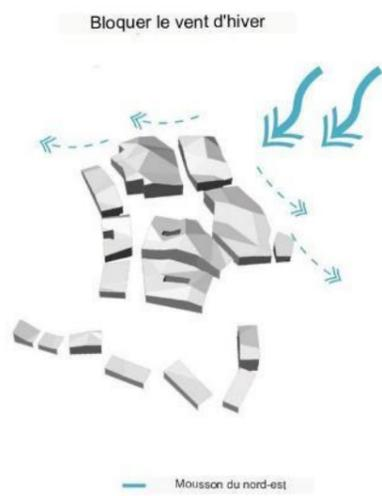
Le regroupement de blocs massifs au nord est réalisé dans le but de protéger le centre contre les vents froids de l'hiver et de minimiser les pertes de chaleur. Cette disposition permet de créer une barrière naturelle contre les éléments climatiques défavorables, assurant ainsi une meilleure efficacité énergétique et
