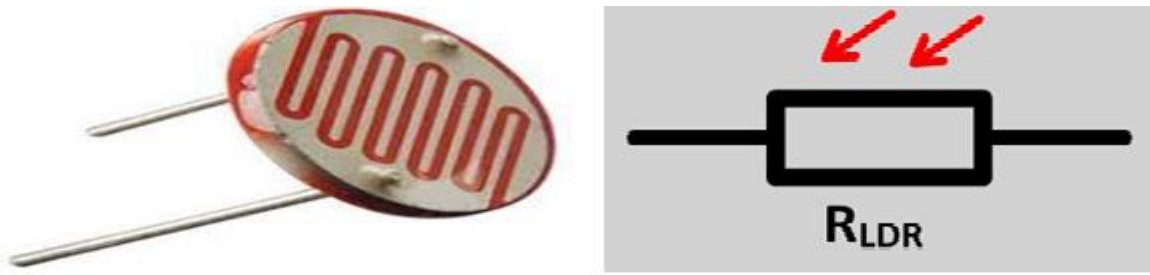
Figure III. 2 - Les capteurs de lumière photorésistance ou LDR et le symbole électrique la flèche indique que la lumière tombe dessus [29]
