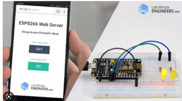
Fig.II.25 : Exemple d'un projet point d'accès WiFi
