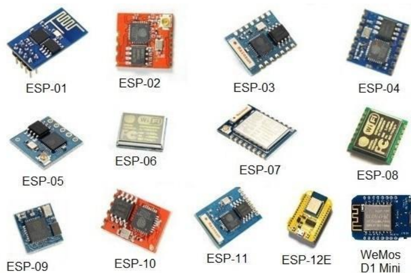
Fig.I.16 : La famille de module ESP8266 [11]
