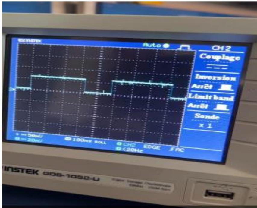
Figure III.10 Signal obtenu à la sortie du 4017 broche 11.
