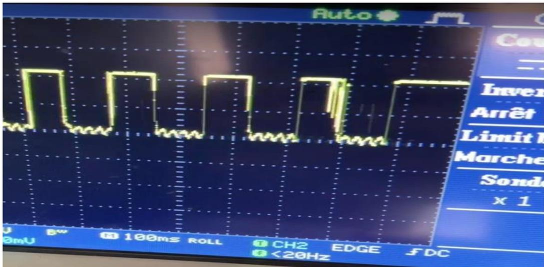
**Figure III.7** Signal obtenu à la sortie de la porte logique NAND C à la broche 10 du CI 4011
