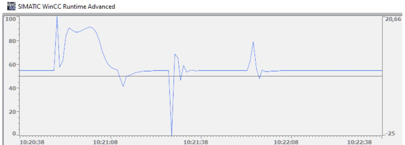
FIGURE 3.22 – Réponse du CEM avec la régulation PI
